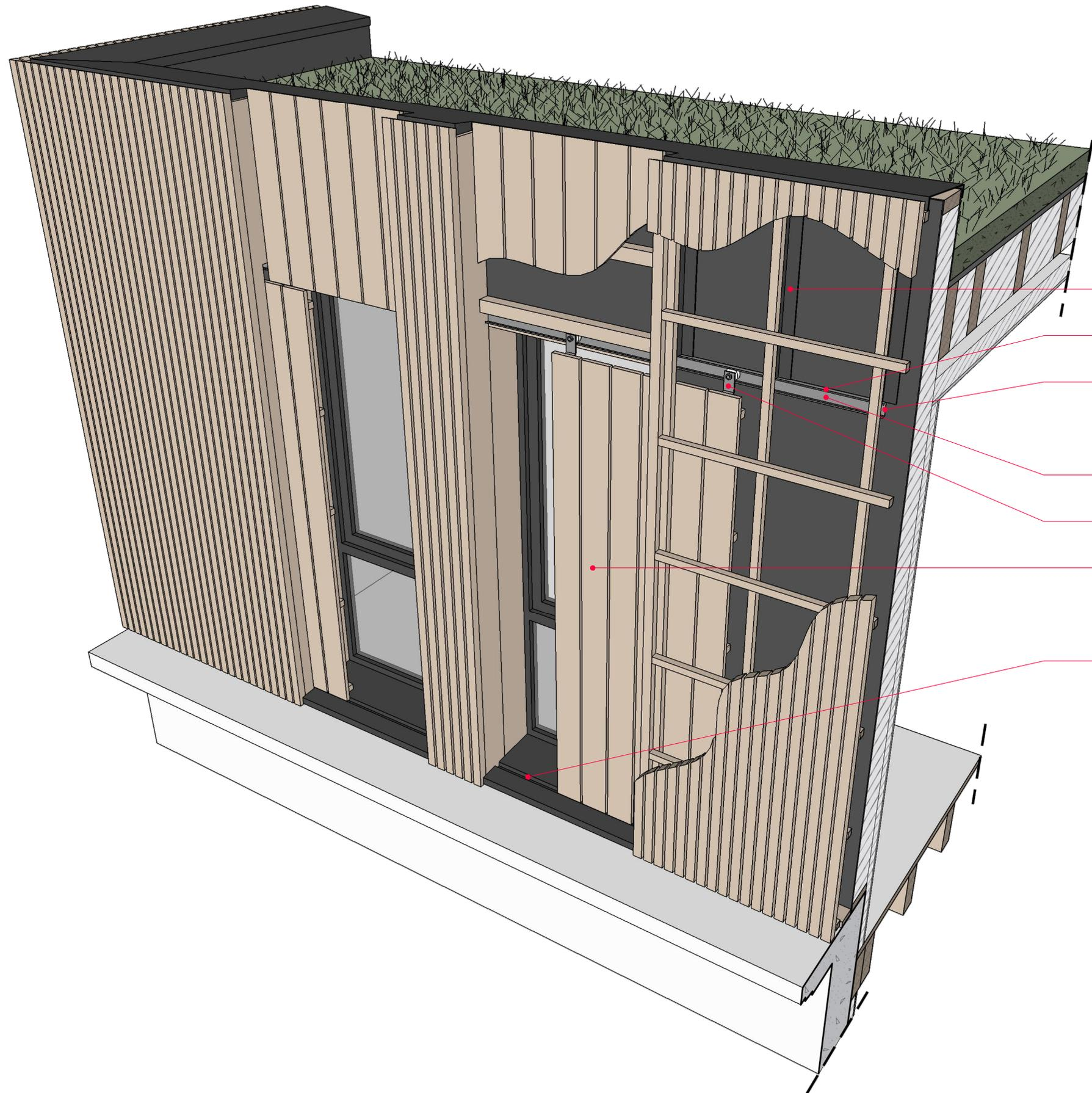
Profil métallique support des tasseaux verticaux permettant l'intégration du volet coulissant derrière le bardage
